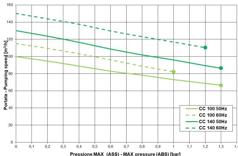
NOTA: Curve riferite alla pressione di 1013mbar (Ass.) e temperatura 20°C (toleranza ±10%)
