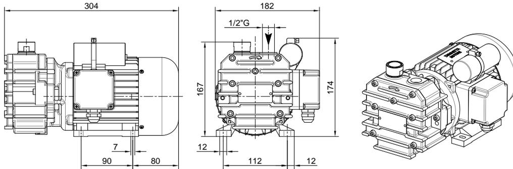
La forma costruttiva di tipo monoblocco con il rotore montato direttamente sull'albero del motore e l'impiego di leghe leggere conferiscono a questa pompa ingombri e peso contenuti per una collocazione anche in spazi ristretti purché sufficientemente aerei. Il raffreddamento della pompa è affidato alla ventola del motore.
